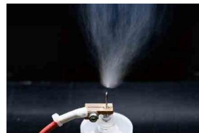
紡糸方向を下から上にするので、作製したサンプルへの液だれ等の汚れを防止します。
