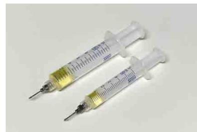
シリンジタイプで少量溶液から試験が可能です。(シリンジサイズは 5ml もしくは 10ml に対応)
