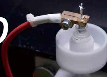
シングルノズルタイプのエレクトロスピンニング装置です。A4サイズのナノファイバーシートを製造するための最適なツールです。コレクターに回転ドラムを採用することで、厚みの必要なサンプルも容易に作製が可能です。
